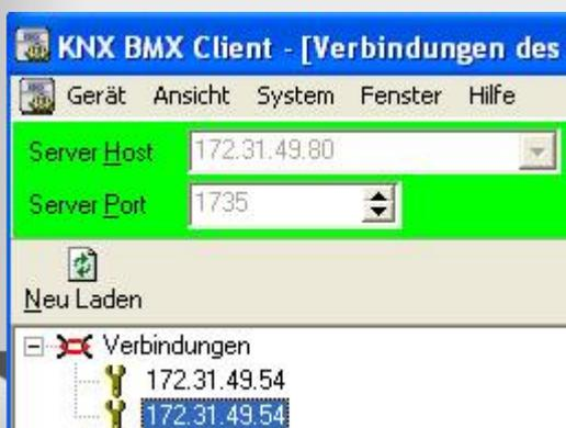
Illustration 28: aktuelle Verbindungen des KNXNode mit KNX Clients
